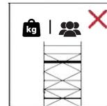
Die maximale Anzahl von Personen, die gleichzeitig auf einer Arbeitsebene sein dürfen, kann begrenzt sein, basierend auf der maximalen Belastung der Konstruktion. Es ist notwendig, diese maximale Belastung durch Personen, Werkzeuge und Material auf der Arbeitsebene im Voraus zu überprüfen und gegebenenfalls zu beschränken.
