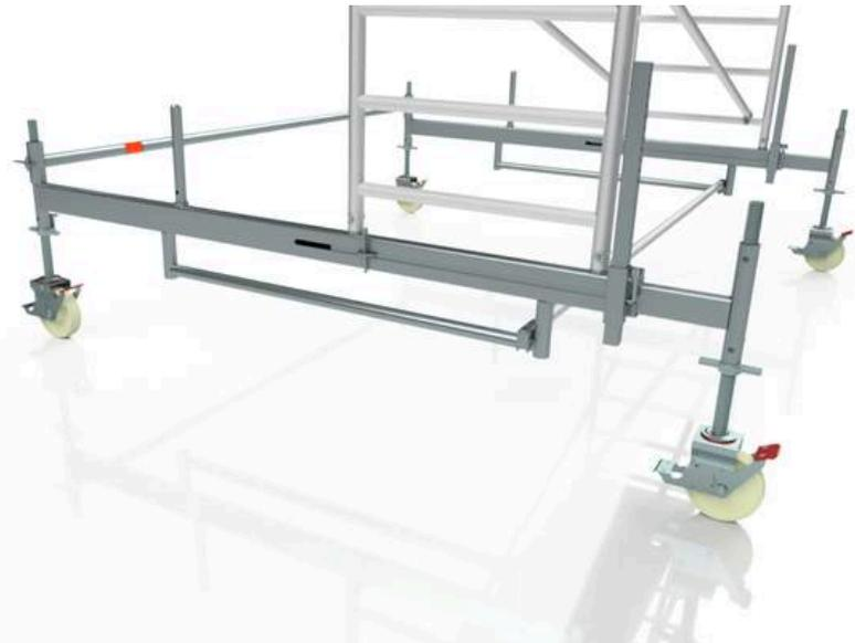
Die Verwendung des Stützrohrs dient ausschließlich zum Umbau der fahrbaren Arbeitsbühnen mit teleskopierbarem Fahrbalken. Während des Umbaus dürfen die fahrbaren Arbeitsbühnen nicht betreten werden. Ein Umbau mit maximaler Ausspindelung ist nicht möglich. Für den Umbau ist die Ausspindelung auf  $L_{Sp} \leq 53$  cm (Abstand Aufstellfläche zu Oberkante Spindelmutter) zu begrenzen.
