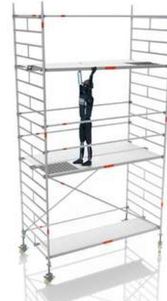
5.4 Hängen Sie jetzt die Durchstiegsbrücke 7 & Belagbrücke 6 auf der fünften Sprosse von oben ein und sichern die beiden Beläge auf beiden Seiten mit der Belagklammer.
