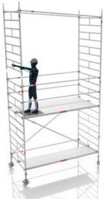
5.3 Heben Sie die Standleiter 10 nach oben und stecken diese ebenfalls in die Rohrverbinder. Sichern Sie diese Standleiter 10 ebenfalls mit Federsteckern wie in Punkt 4.6.
