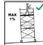
Die maximale Neigung bei einer fahrbaren Arbeitsbühne darf 1% (in horizontaler Ausrichtung) nicht überschreiten. Fahrbare Arbeitsbühnen müssen durch die Spindelung an den Lenkrollen oder durch Unterlegung von geeigneten Materialien lotrecht gestellt werden.
